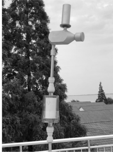
图 5.6 系统空白测试颗粒物过滤器安装实物图
