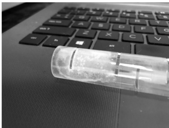
图 5.13 碳酸钠外标溶液测试后的石英管
